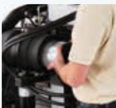
Der Motorluftfilter ist leicht zu kontrollieren, zu reinigen und auszuwechseln. Dafür werden keine Werkzeuge benötigt.
