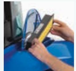
Der Luftfilter kann ohne Werkzeuge und Geräte kontrolliert, gereinigt und ausgewechselt werden.
