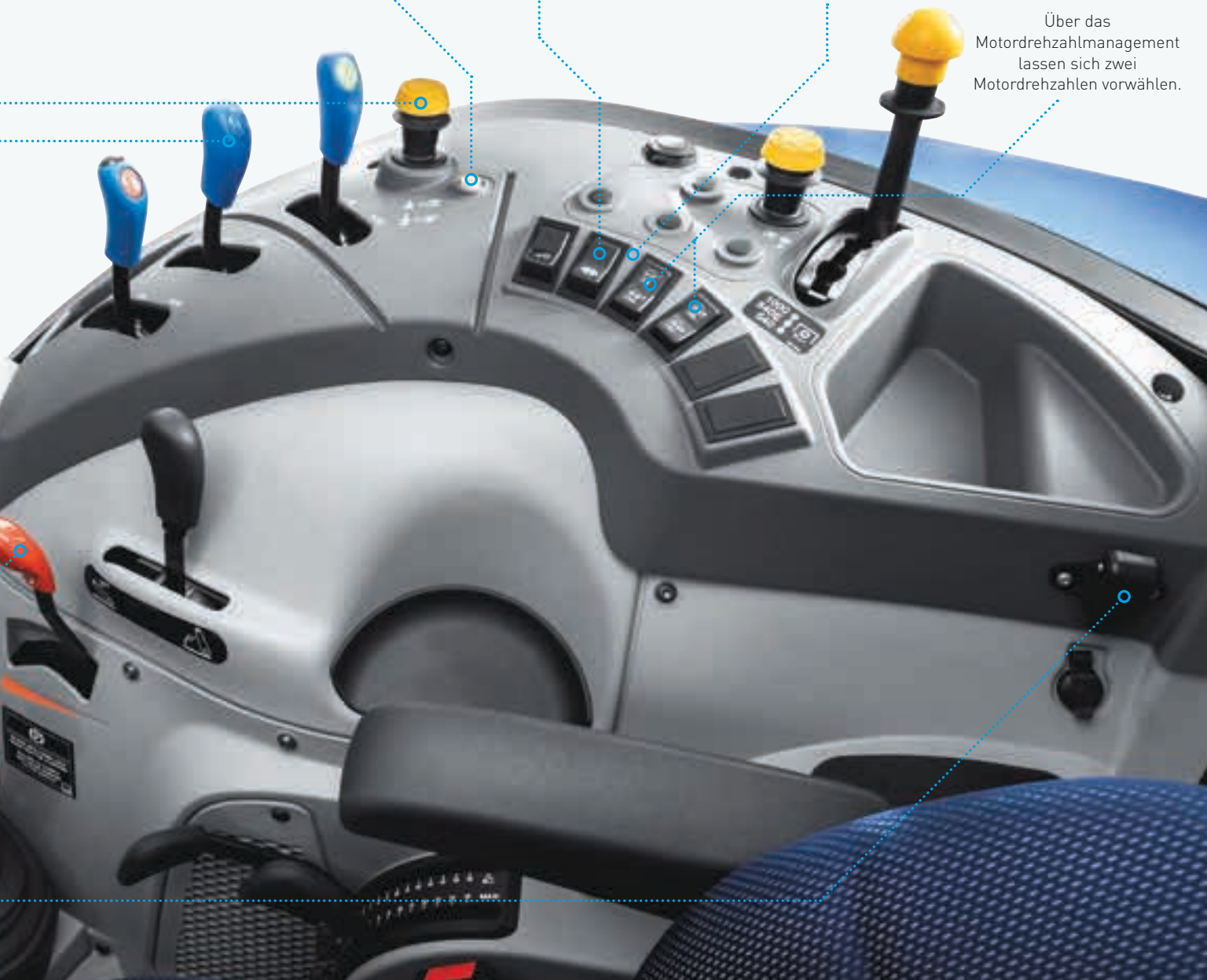
Alle Schalter sind hintergrundbeleuchtet, was die Arbeit bis spät in die Nacht erleichtert. Die Hintergrundbeleuchtung wird beim Einschalten der Traktorbeleuchtung automatisch aktiviert.
